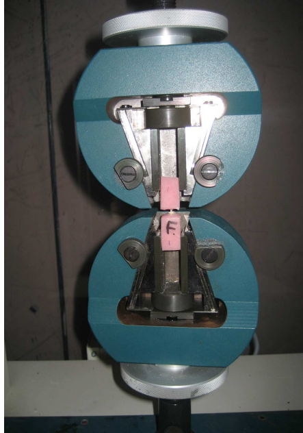
Imagen 15. Colocación de las muestras en las bases del tensómetro.
