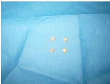
Fig. 11. muestras fotopolimerizadas de 1.8mm de grosor de ambos materiales.
