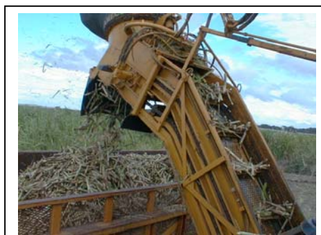
Foto# 41 Cadena transportadora de elevador.
