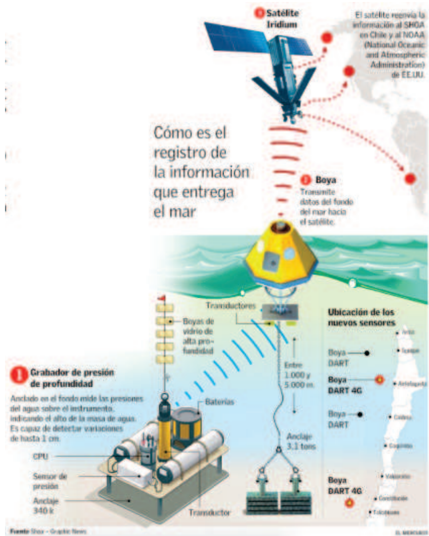
Figura 3. Funcionamiento del sistema de boyas marinas en Chile
