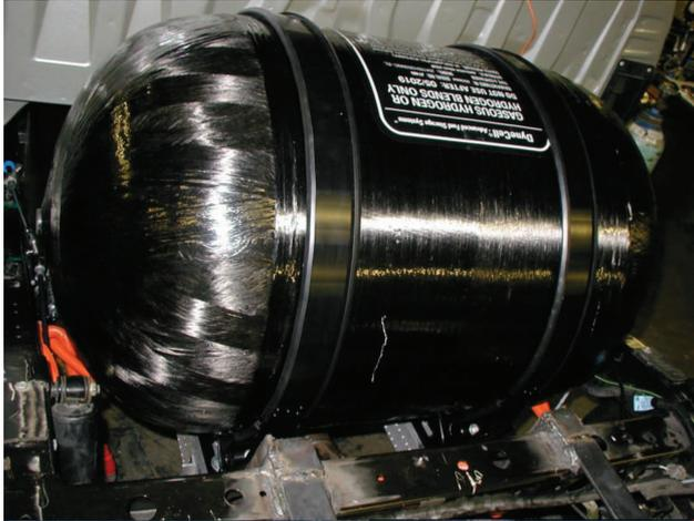
Un lapso de recarga de combustible de menos de 5 minutos se apunta para el 2015. La tecnología actual para el almacenaje del hidrógeno es en tanques en los cuales se almacena como un gas comprimido o como líquido superenfriado, donde es fácilmente accesible para el uso.
