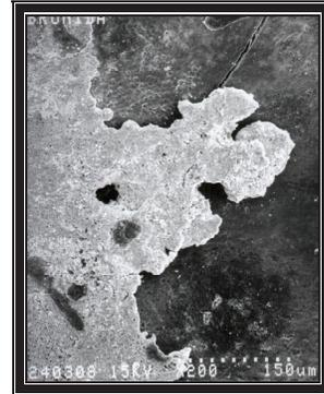
\* Después de bruñir la restauración, se observa: que la superficie aún es rugosa y apta para la retención de placa bacteriana, además, se tiene el riesgo de producir sobreobturaciones invisibles clínicamente.
