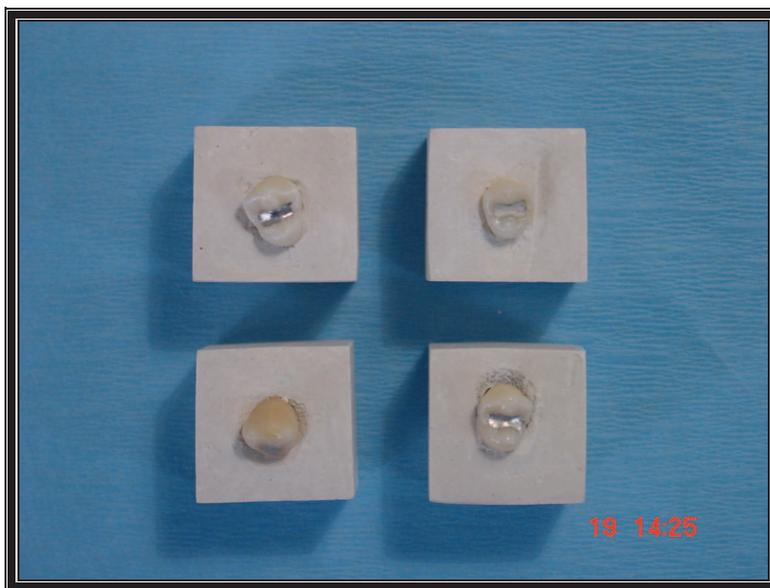
Se muestra la pieza superior izquierda que fue pulida con el kit Henry Shein, la pieza inferior izquierda esta obturada y sin bruñir, mientras que la pieza superior derecha esta obturada y bruñida, y por último la pieza inferior derecha se pulió con el kit Diatech.
