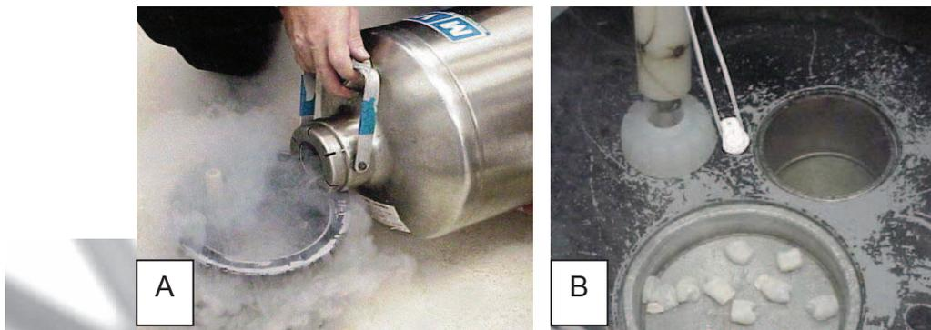
**Fig. 14 A, Nitrógeno líquido. B, Colocación de las piezas en nitrógeno líquido.**
