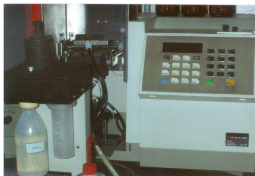
Fotos N°4 y 5: Espectrofotógrafo de vapor en frío marca Perkin-Elmer del Laboratorio Químico Lambda. En éste se analizaron las muestras de sangre, cabello y aire (tomada en el año 00).
